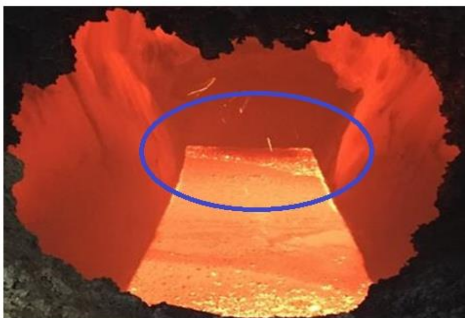
Рисунок 5.1 – Скопившийся уголь на поверхности шлака
