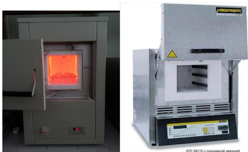
а – общий вид печи СНОЛ 12/16 (Россия); б – печь высокотемпературная камерная HTC 08/16 Nabertherm GmbH.
